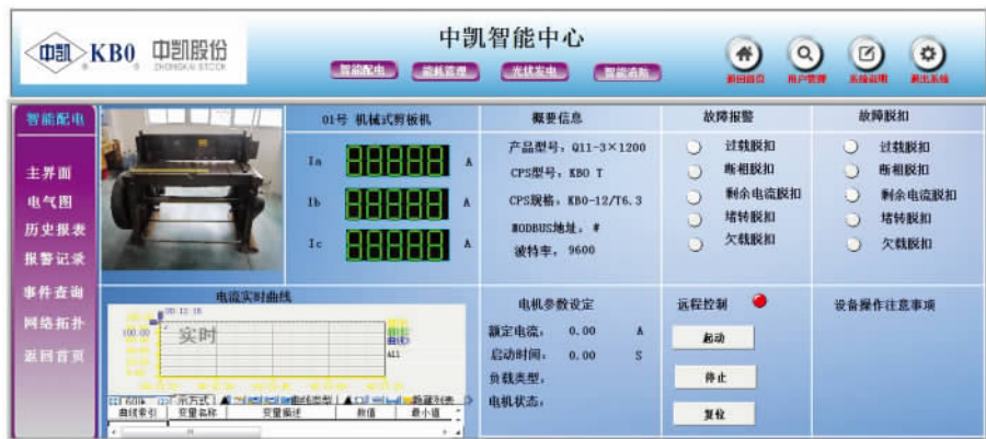
图2 智能配电系统人机界面
