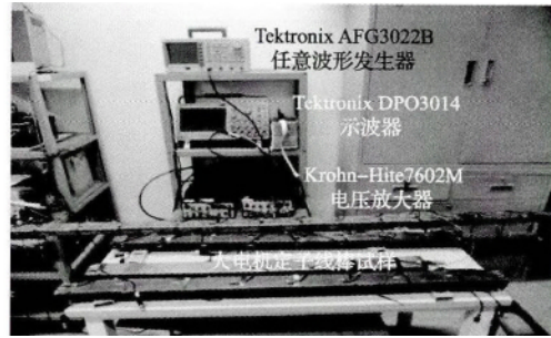
图 7 定子绝缘损伤检测实验装置图
